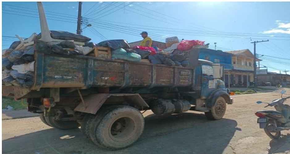
Caminhão da prefeitura realizando a coleta/transporte dos resíduos, operação irregular e insegura .
